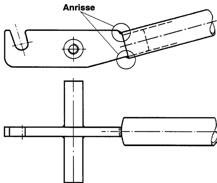
Diese Anrisse können durch nicht ganz sachgemäße oder zweckfremde Verwendung des Hebels entstehen. Bei weiterer Benutzung des angerissenen Hebels besteht die Gefahr, daß der Hebel an dieser Stelle bricht. Eine Verletzungsgefahr für den Benutzer kann dabei nicht ausgeschlossen werden.
